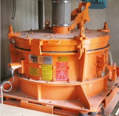
RPM 1113 使用砾石 (16 - 32 mm) 生产混凝土砂子 (0 - 2 mm)
