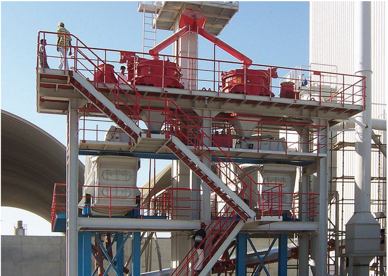
干砂浆设备中安装了两台 RPM 1513 型转子冲击式破碎机，阿拉伯联合酋长国 (UAE)
