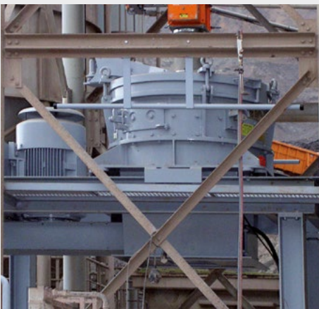
RPM 1113 使用剩余颗粒 (2 - 5 mm, 安山岩) 生产优质碎石砂 (0 - 2 mm)
