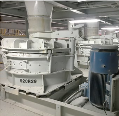
RPM 1513 & RPMF 1516 使用石灰石 (8 - 20 mm) 制造干砂浆砂子 (0 - 1.6 mm) 对比
