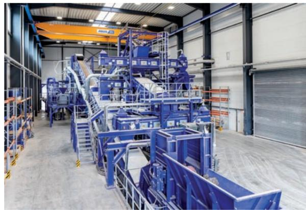
Im Test Center kann BHS die verschiedenen Stufen des Feinaufbereitungsprozesses mit den Materialsortierverfahren vorab simulieren, um detaillierte Analysen des Kundenmaterials zu erzielen
