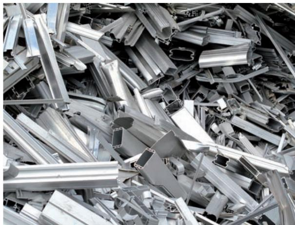
Eine Herausforderung bei der Feinaufbereitung von Aluminiumschrott ist die große Bandbreite des Ausgangsmaterials: Sowohl die Art des Schrottes als auch die Materialzusammensetzung variiert je nach Einsatzgebiet, Herkunftsland oder -region erheblich.
