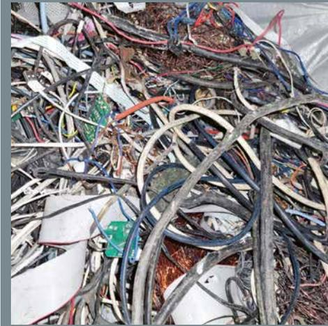
Lange Kabel werden bereits in der ersten Sortierstufe manuell abgeschnitten und entfernt.
