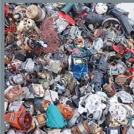
Nach der Vorzerkleinerung im VSR werden kleine Elektromotoren aussortiert.
