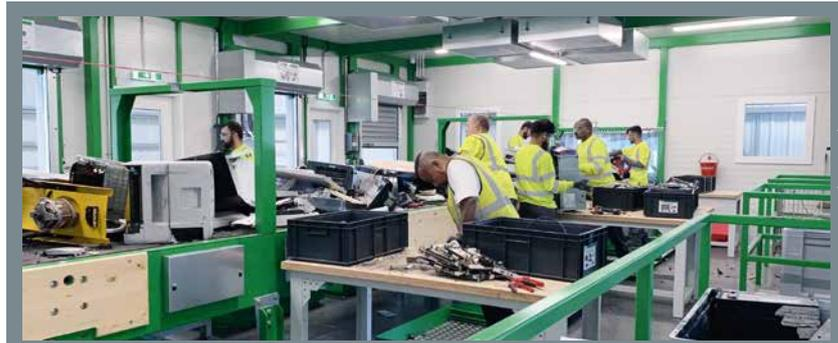
In der Sortierstufe 1 werden bei der manuellen Vorsortierung Störstoffe wie beispielsweise Batterien, Akkus, Kondensatoren, Kabel, Tonerkartuschen, TV-Bildschirme, Displays, Mainboards oder massive Teile demontiert und aussortiert.
