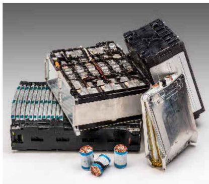
Typisches Inputmaterial für das Recycling: Produktionsabfälle sowie ausgediente Batteriemodule und Packs. Foto: BHS-Sonthofen
