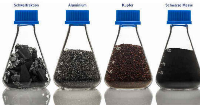
Mit dem Recyclingverfahren lassen sich etwa 95 % der in einer Batterie vorhandenen Materialien wie Kupfer, Aluminium, Kunststoffe und die schwarze Masse mit Lithium, Kobalt und Nickel zurückgewinnen. Die Schwerfraktion bezeichnet die zerkleinerten Batterien. Foto: BHS-Sonthofen
